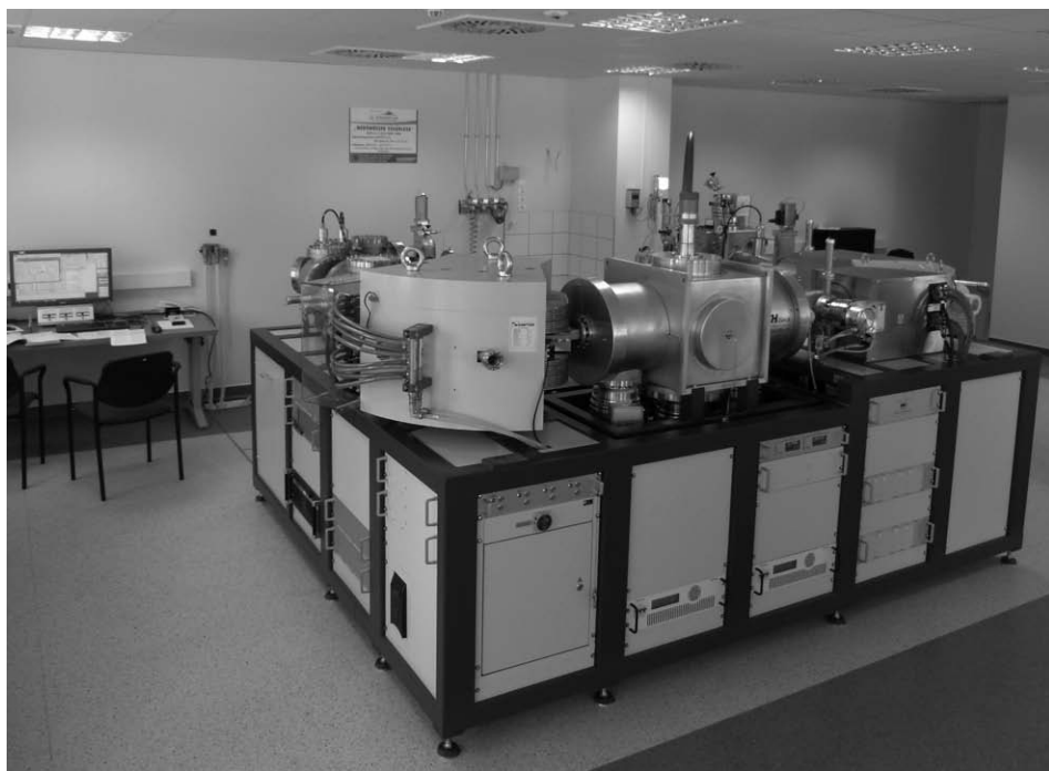
7. ábra • EnvironMICADAS gyorsító tömegspektrométer ^{14}\text{C} -mérésekre a Hertelendi Környezetanalitikai Laboratóriumban, MTA ATOMKI – Isotoptech Zrt., Debrecen
