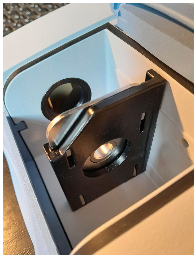
7. kép. Tablettatartó a transzmissziós modul mintatérében
