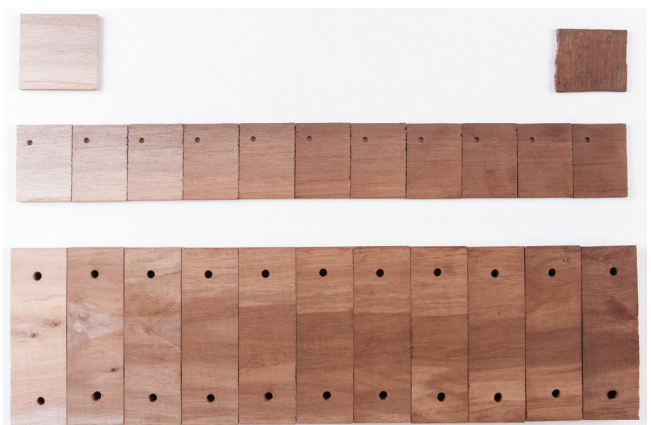
14. kép. Diófa lapokból különböző hőfokokon készített mintasor
