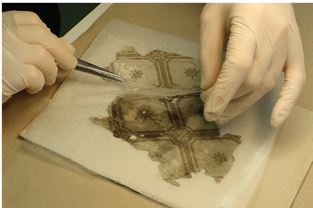
12. kép. A segédanyag leválasztása a tapéta felületéről
