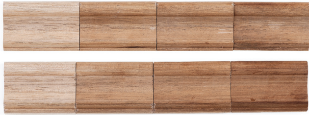
15. kép. Vastagabb diófa elemekből különböző hőfokokon készített mintasor
