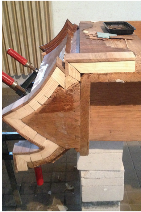
11. kép. A fenyő alapfa kis kezeletlen darabokból összeállított kiegészítése az öregített borítással
