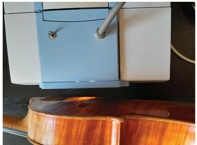
9. kép. Egy Gand & Bernardel hegedű (1890-es évek eleje) hátlapjának reflexiós lakkvizsgálata
