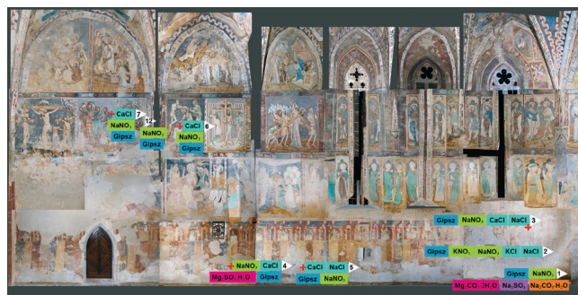
11. kép. A szentély kiterített képe. A függőleges falak sótérképe. A piros + azokat a részeket jelöli, ahol a mintákból kioldott sóoldat higroszkóposnak bizonyult. A térképen fel van tüntetve a vízdoldható sók előfordulása, eloszlása is. A falkép a déli fal (jobb oldal) alsó részén pusztult el teljesen, a keleti részen (közép) alul kisebb zónában, az északi falon (baloldal) alul kevésbé, de a sekrestye boltozatának vállrészénél – kb. 1–2,5 méter magasság között – az összegyűlt víz és sókár miatt nagy területen. G. Kovács G. felvétele.
