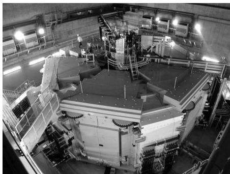
4. ábra • A RIBF-gyorsítóberendezés szupravezető ciklotronja
